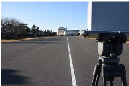
図 3 日本大学理工学部交通総合試験路におけるミリ波実験レーダを用いた落下物検知実験風景
