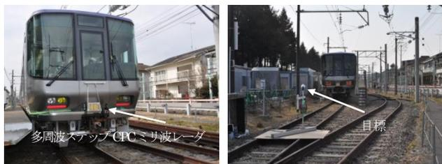
図1 鉄道車両搭載図
