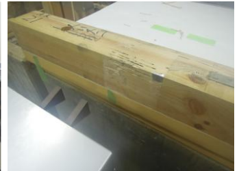
図3 木材内部シロアリ検知実験
