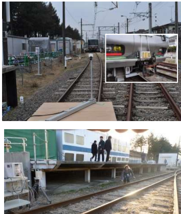
多周波ステップCPCミリ波レーダを用いた鉄道環境試験
